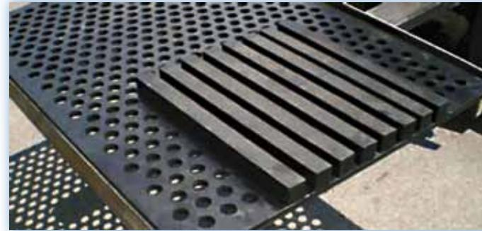
Tole revetue de caoutchouc avec trous ronds 30 et barre de protection sur le point de chute.
